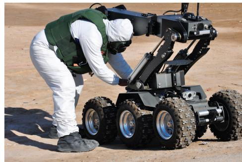
Mise en place d'un mini drone d'observation sur la plateforme d'emport montée à l'avant du robot d'intervention CBRNE
