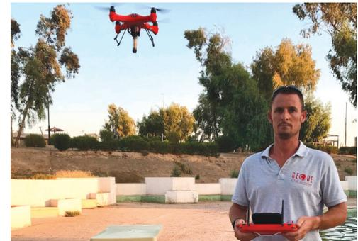
Essais du drone d'observation équipé d'un dispositif de transport et largage de charge à distance
