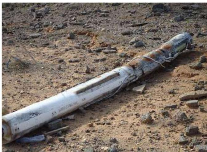
*Moteur de roquette avec composants électroniques et carburant solide.* Source ©M. Guilbaud
