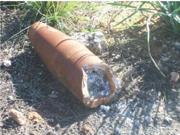
Rupture du corps exposant le chargement
