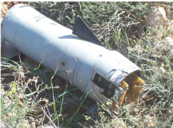
Rupture du dispositif propulsif exposant des composants
