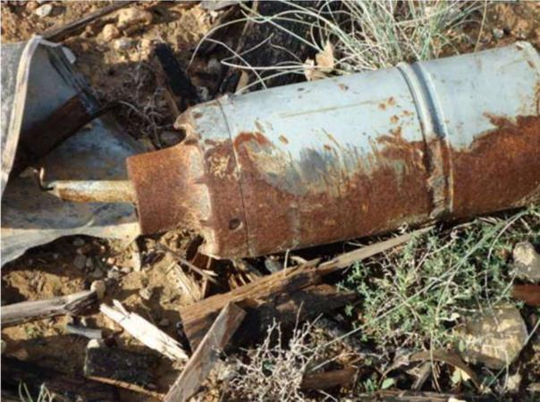
Rupture du dispositif d'amorçage « stand off »
